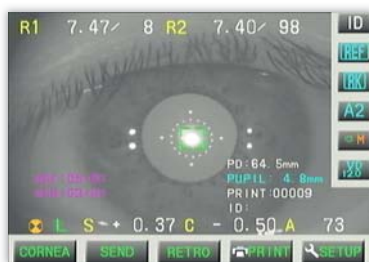
Bildschirmdarstellung einer kombinierten Ref-Kerato-Messung
